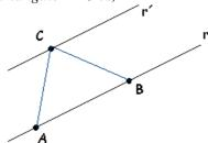
En el cálculo del área del triángulo interviene la base que será d(A,B) y la altura que será d(C,r). Como las rectas r y r' son paralelas d(C,r) = d(r',r) = 6 (calculada en el apartado b)
